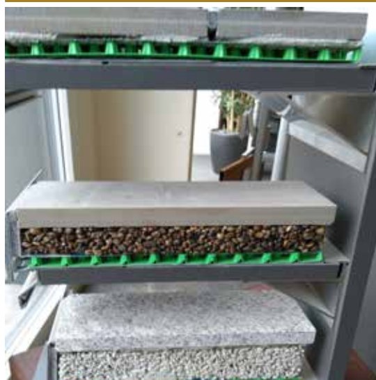
Construction liée (Dalle en béton)
